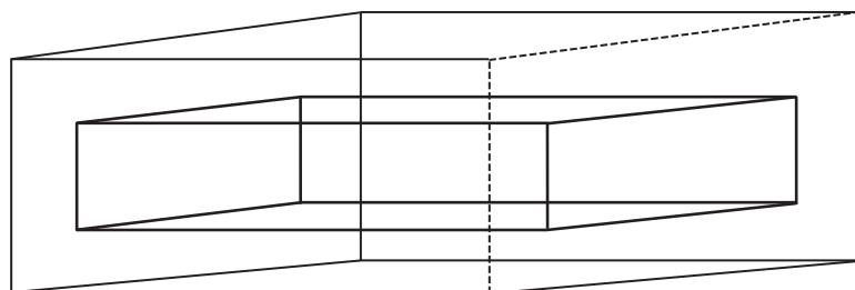
Quaeritur quae sit ratio rupturae centralis ad liberam ut si Trabs in fig. 1 ita appendatur in fig. 4 vel saltem homo eam recta e muro educere conetur. Et primum data 10 centrali resistentia invenire liberam: Reducatur basis  $abc$  fig. 1 quaecunque sit, in rectangulum per methodum superiorem determineturque pondus aequilibrans ejus firmitati
